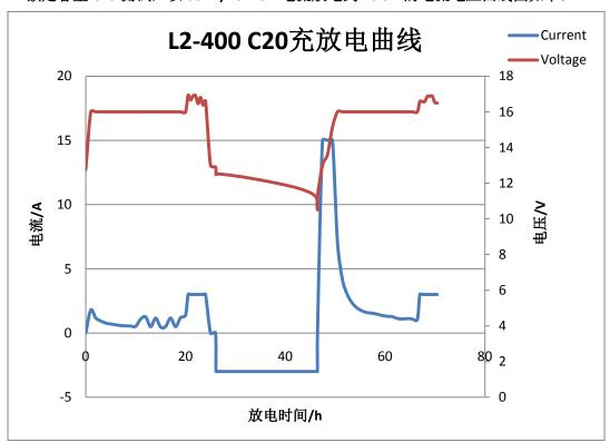
2. 冷启动 CCA 测试: 以 580A@-18°C 电流放电的电流电压曲线图如下:
